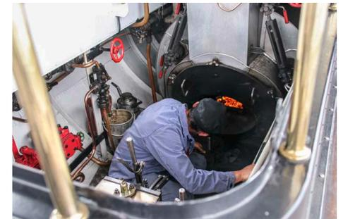
Der Heizer muss die Dampfmaschine schmieren, Injektorwasser in den Seewassertank giessen und Feuer sowie Glutbett kontrollieren.
