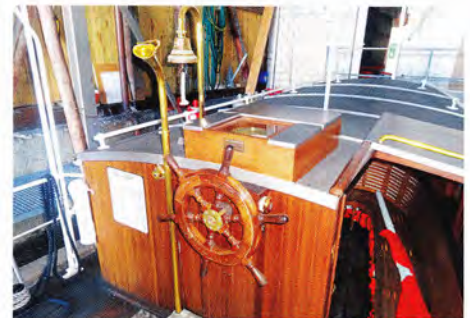
KAPITÄNSPLATZ: Stand des Schiffsführers mit Sprachrohr, Glocke und Ruderrad.
